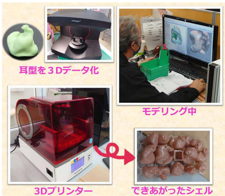
個人の耳に合わせたオーダーメイド補聴器の作成では、イヤモールド(耳栓)を作る時と同様に、まず印象剤で耳型を取ります。その耳型を左上の黒い機器で**3Dデータ化**しパソコンに取り込むところから補聴器の製造が始まります。右上の**モデリング中**と書いた写真は、技術者が3Dデータ化された耳型の中にマイク(集音するところ)、レシーバー(音を出すところ)、アンプ(音を増幅・加工するところ)などの補聴器の部品をどのように設置していくかデザインし、設計図を作っているところです。ひとりひとり耳の穴の大きさや曲がり方は異なります。欧米の男性に比べ、日本人女性の耳はだいぶ小さいのではな
